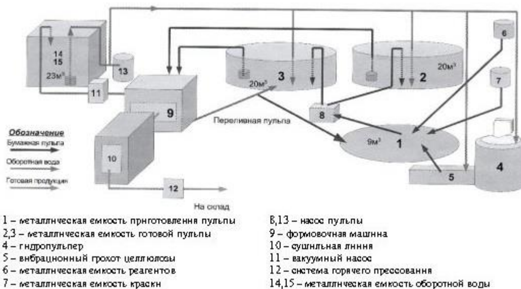
Рисунок 4 - Принципиальная схема производства тары и упаковки из бумажной пульпы (схема грузопотока)
